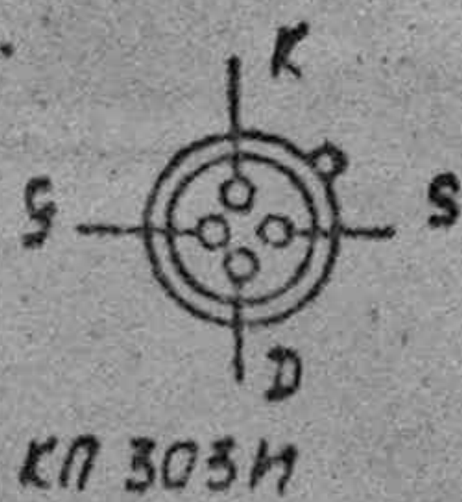
Anordnung der Anschlüsse der Transistoren und Mikroschaltungen
