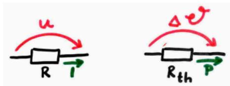
Figure 82: Analogie ohmscher Widerstand zu thermischer Widerstand
