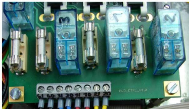
Figure 9: Sicherungen im THT-Sockel
