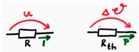
Figure 84: Analogie ohmscher Widerstand zu thermischer Widerstand
