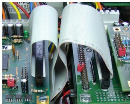
Figure 14: Flachband / Pfostenleisten
