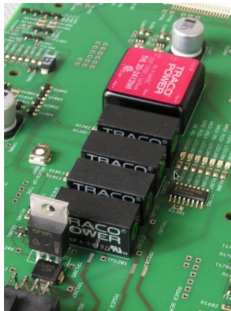
Figure 59: TO220 und herstellerspezifisch (TRACO)
